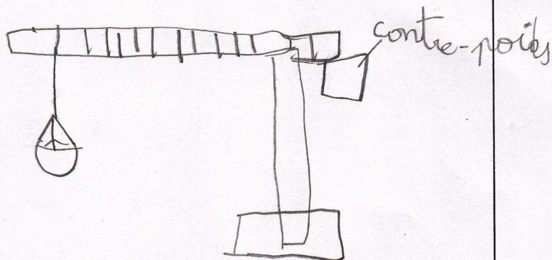
Conclusion de la classe : Nous avons réussi à soulever une charge de 1 kg avec une grue. Pour cela, nous avons utilisé une contre-poids qui a permis d'équilibrer la grue.
