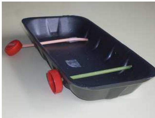
Les roues sont bloquées par la colle : ça ne roule pas, ça glisse
